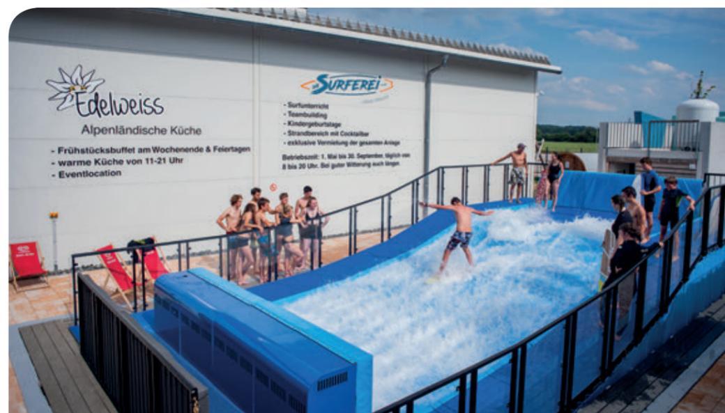
**T**atsächlich ist jetzt das Surfen mit Strandfeeling im Voralpenland ab sofort möglich: Bei der Außenanlage der Kletterei handelt es sich um eine sogenannte „stehende Welle“; die Wellen werden durch Druckpumpen simuliert. Der Wasserfilm hat eine Höhe von nur 10 Zentimetern, was erhebliche Vorteile im Bereich Sicherheit mit sich bringt. Das Wasser der Anlage ist angenehm warm, da es beheizt wird. Rund herum sorgen Schaumstoffpolsterungen für weiches Aufkommen bei einem eventuellen Sturz.
